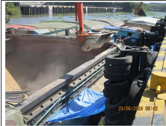
ภาพที่ 2.1-11 : ซิงผ้าใบระหว่างกาบเรือกับท่าเทียบเรือ ขณะขนถ่ายสินค้าโดยใช้แบคโฮ
